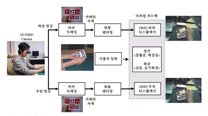
그림 1. 전체 시스템 Fig. 1. Overall system.
