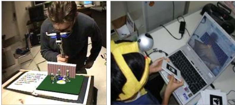
[그림 29] 카메라를 이용한 증강현실 시스템: Head Mounted Display 사용 (왼쪽), 모니터 사용 (오른쪽)
